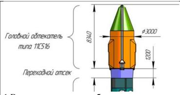
1.Вычислите площадь обшивки головного обтекателя космического корабля «Союз-2», в котором располагался полезный груз, если высота конусообразной части относиться к цилиндрической как 1:2.
